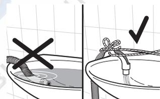
– Во избежание выскальзывания застрахуйте место вывода шланга к сливному отверстию раковины или ванны с помощью входящего в комплект поставки насадного колена. В противном случае шланг может быть силой отдачи вытекающей воды выдавлен из раковины.
