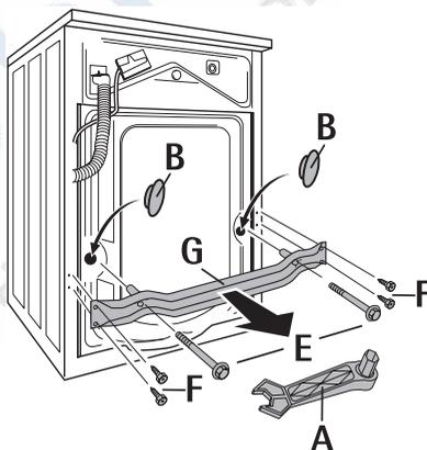
**Внимание!** Вдвиньте колпачки так сильно, чтобы они зафиксировались в задней стенке (брызгозащита внутренней камеры прибора).
