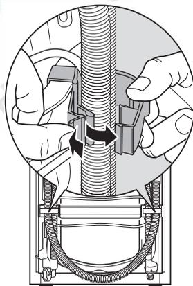
2. Сильным движением снимите оба крепления для шлангов.
