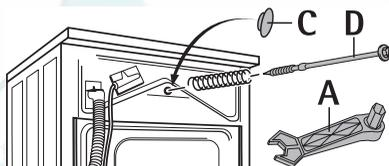
**Внимание!** Вдвиньте колпачок так сильно, чтобы он зафиксировался в задней стенке (брызгозащита внутренней камеры прибора).
